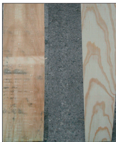
Photo 4 Planche de Pin maritime avant rabotage (gauche) et après rabotage (droite)
