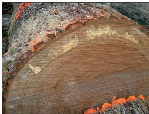
Photos 1 et 2 Échauffure d'aubier sur Chêne (à gauche) et sur Épicéa (à droite)
