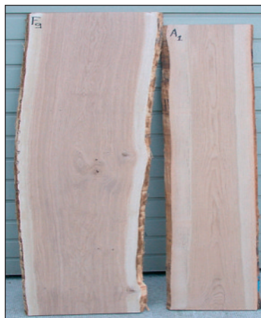
Photo 3 Planche de Chêne fraîchement récolté (gauche) et conservé sous arrosage (droite)
