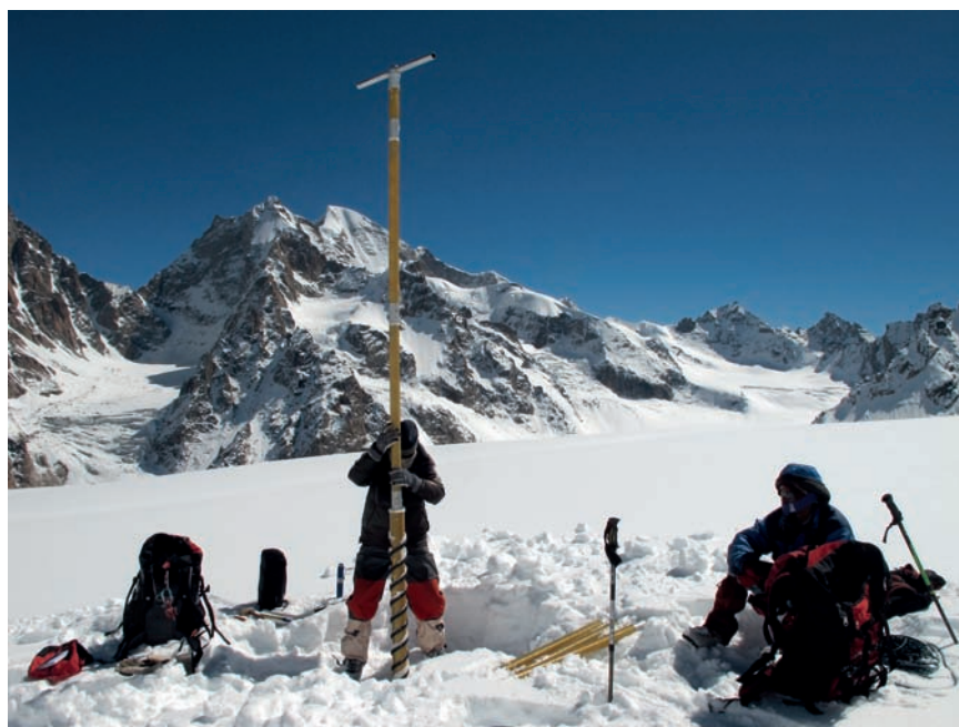
Figure 2. Mesure d'accumulation à l'aide d'un carottier manuel dans la zone d'accumulation (5 300 m) du glacier Chhota Shigri, Himachal Pradesh, région Lahaul et Spiti, Inde du Nord, octobre 2011. Programme Glacioclim/Cefipra. © P. Wagnon
