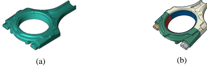
FIG. 1 – Palier de tête de bielle mono-corps (a) et multi-corps (b)
