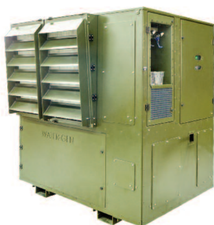
Figure 3 : Système de production d'eau par condensation active de la vapeur d'eau atmosphérique (crédits photographiques : WaterGen®). Le modèle présenté ici a une capacité de production pouvant aller jusqu'à 500 litres par jour, en conditions optimisées, pour un encombrement de l'ordre de 2 m 3 .
