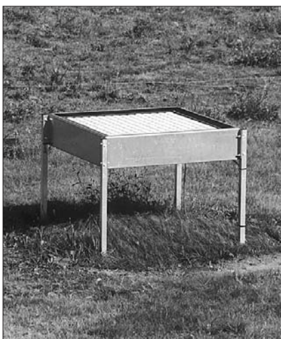
Un sodar Doppler utilisé par EDF pour la mesure du vent. (Photo EDF)
