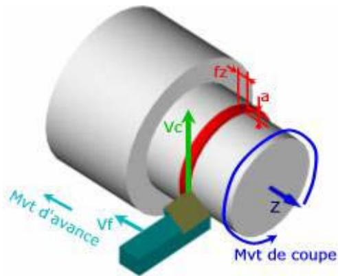
FIG. 2 – Schéma d'une opération de tournage
