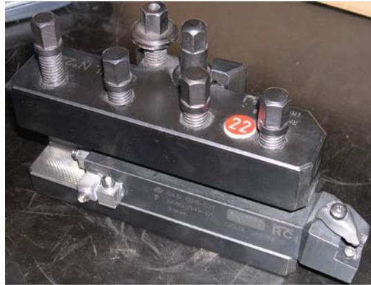
FIG. 3 – Porte-outil instrumenté
