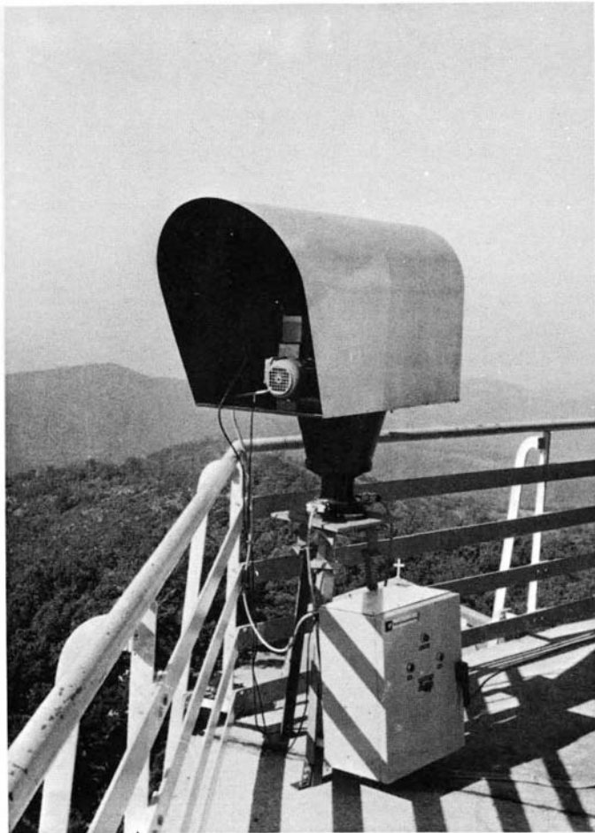
Photo 4 - Appareil expérimental de détection automatique des incendies (C.E.R.T. - O.N.E.R.A.).
