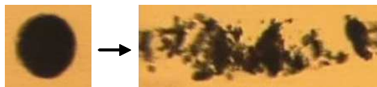
FIG. 7 – Illustration du mécanisme de désintégration pour un agglomérat de silice Z1115MP dans du SBR. R_0 = 37\mu\text{m} , \dot{\gamma} = 56\text{ s}^{-1} Photos extraites du travail de [5].
