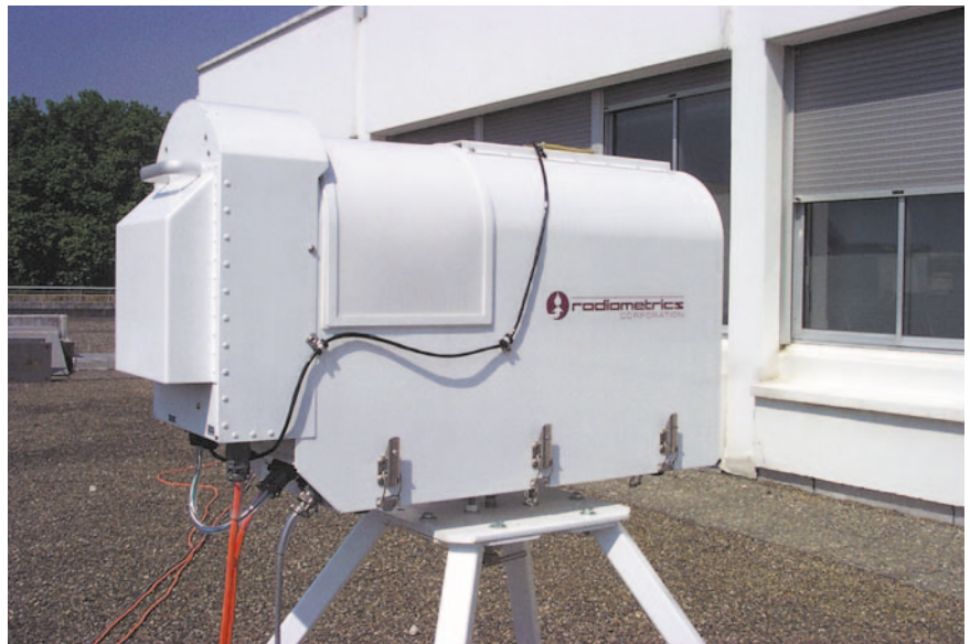
Figure 2 - Radiomètre micro-ondes commercialisé par la société Radiometrics. Ce type d'instrument est capable de mesurer automatiquement des profils verticaux de vapeur d'eau.
