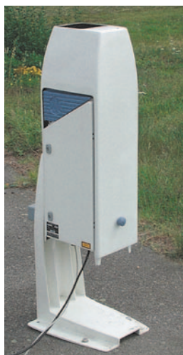
Figure 5 - Télémètre de nuages à laser CT25K de la société Vaisala, actuellement en cours de déploiement dans le réseau d'observation de Météo-France. Ce télémètre est en fait un lidar rétrodiffusion fonctionnant à 0,9 µm. Sa portée de mesure est limitée à 7 500 mètres d'altitude.
