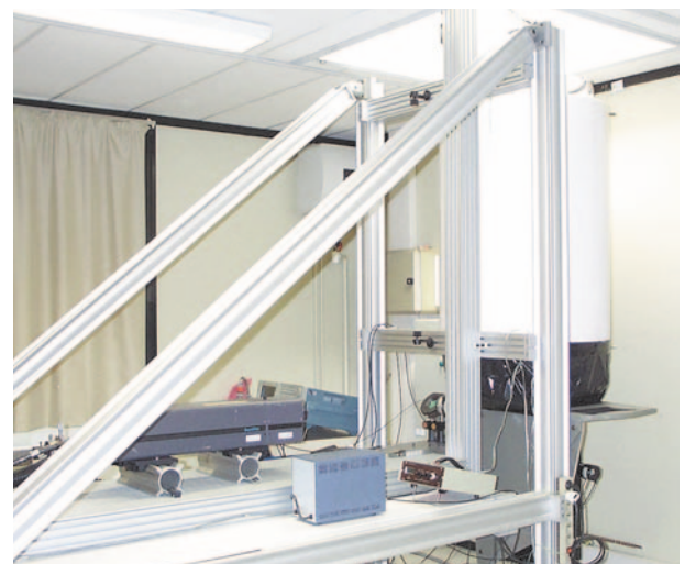
Figure 3 - Le lidar rétrodiffusion du site instrumenté pour la recherche en télédétection atmosphérique (Sirta) de l'Institut Pierre-Simon Laplace. On voit notamment le laser, disposé horizontalement à gauche, et le télescope de réception, disposé verticalement à droite. Ce lidar fait partie du réseau Earlinet.
