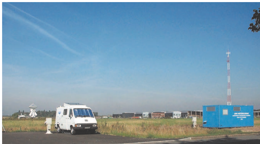
Figure 8 – Le site instrumenté pour la recherche en télédétection atmosphérique (Sirta) à Palaiseau. De gauche à droite, le radar Doppler Ronsard à 5 GHz pour les précipitations, le radar Doppler Rasta à 95 GHz pour les nuages, le lidar vent Doppler LVT à 10,6 \mu\text{m} pour la dynamique et le mât instrumenté de 30 mètres, en voie d'équipement en capteurs in situ et en radiomètres. (Photo IPSL, Martial Haeffelin)
