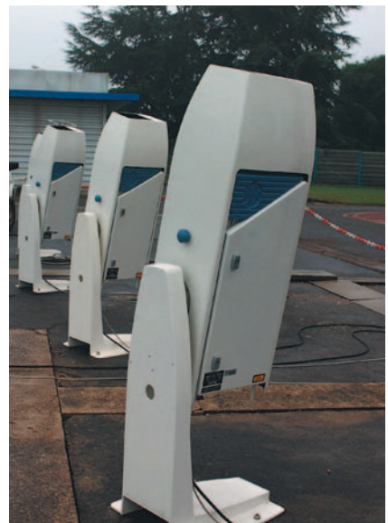
Photo 10 - Trois télémètres de nuages à laser Vaisala CT25K en cours d'essais à Trappes. (Photo Météo-France, P. Taburet)
