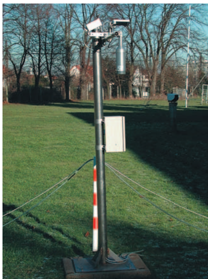
Photo 5 - Essais de capteurs de temps présent au Puy-en-Velay (Haute-Loire). Le mât porte (tout à fait en haut) deux détecteurs de précipitations, le Thies et le Kriwan, et un capteur de hauteur de neige Campbell (cylindre vertical à l'extrémité de la tige horizontale).
