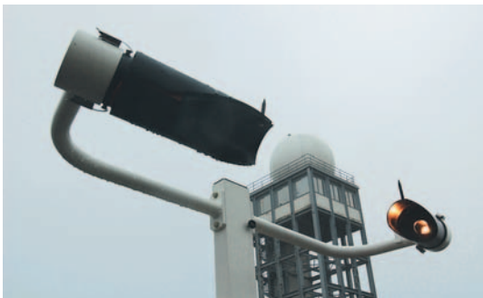
Photo 4 - Le diffusomètre Degréane DF20. En arrière-plan, la tour radar de Trappes. (Photo Météo-France, P. Taburet)
