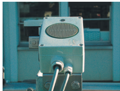
Photo 7 - Vue rapprochée du détecteur de précipitations Kriwan.
