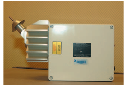
Photo 3 - Le détecteur de givre Rosemount 872H3, avec sa tige vibrante à l'extrémité gauche. (Photo Météo-France, P. Taburet)
