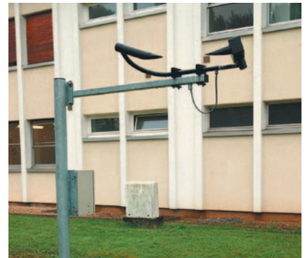
Photo 8 - Le capteur de temps présent Vaisala PWD11, capable de détecter et d'identifier les précipitations, mais aussi de mesurer les faibles visibilités. (Photo Météo-France, P. Taburet)
