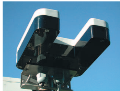
Photo 6 - Vue rapprochée du détecteur de précipitations Thies.
