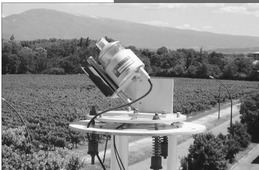
Héliographe Cimel à fibre optique. Une fibre optique en rotation intercepte le rayonnement solaire direct. C'est l'instrument utilisé dans le réseau de mesures de Météo-France. (Photo Météo-France, J.-P. Morel)
