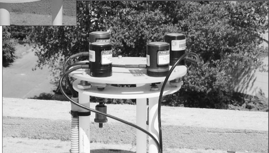
Deux radiomètres UV Solar Light Co. Chacun d'entre eux comprend un élément destiné à la mesure de l'UV-A (320-400 nm) et un élément destiné à la mesure de l'UV-B (280-320 nm). (Photo Météo-France, J.-P. Morel)
