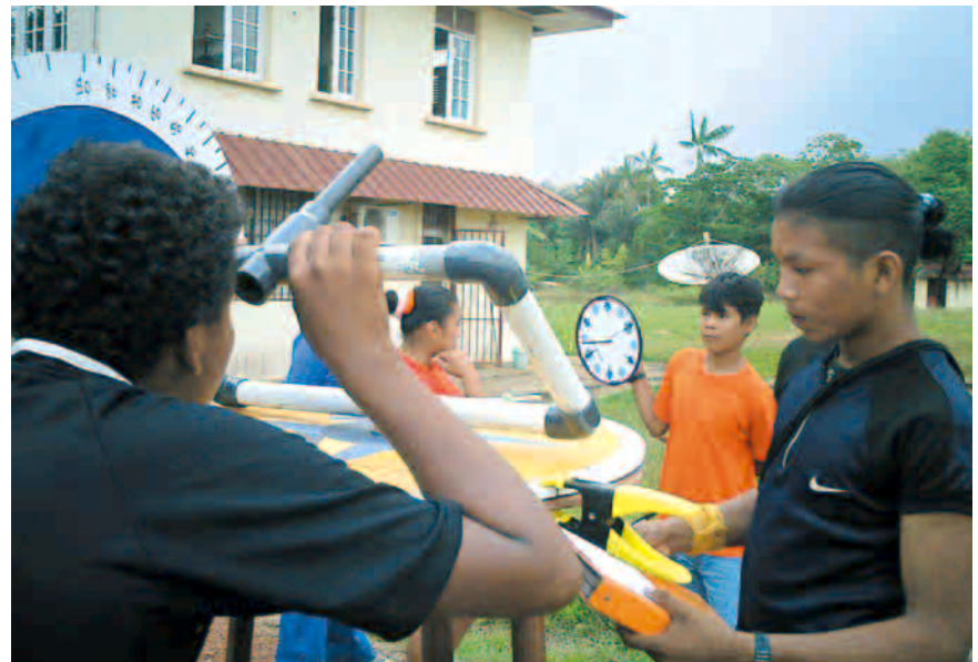
Ce théodolite pour enfants donne les indications d'angle nécessaires pour suivre le ballon et en déduire le vent en altitude. (Photo M. Riffiod)
