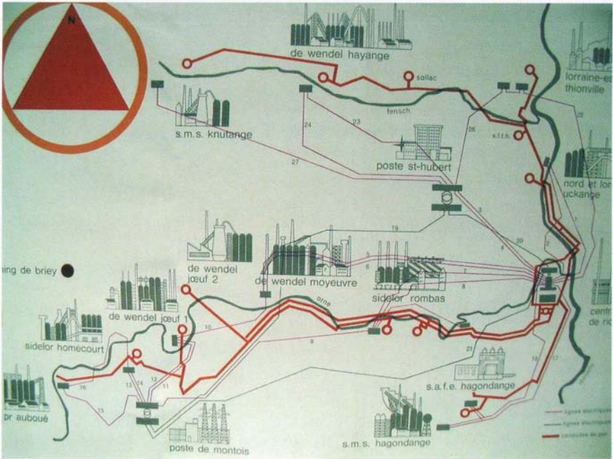
Les réseaux gaz et électrique de la Centrale Sidérurgique de Richemont
