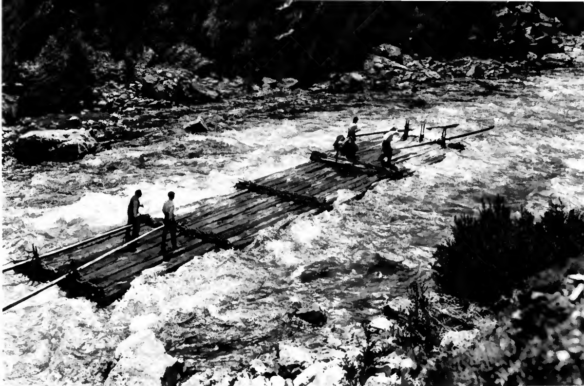
▲ Descente d'un radeau par le rio Esca : les troncs sont reliés par des branches flexibles
