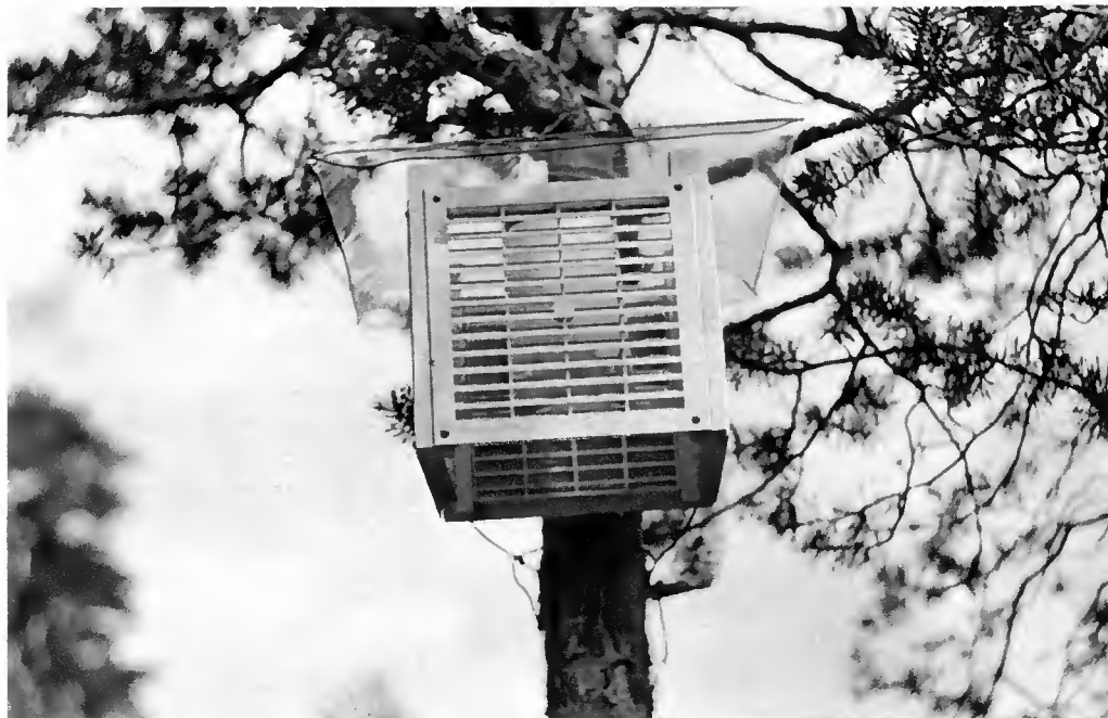
Dispositif du papier imprégné de chaux permettant de déterminer l'intensité de la pollution par le fluor
