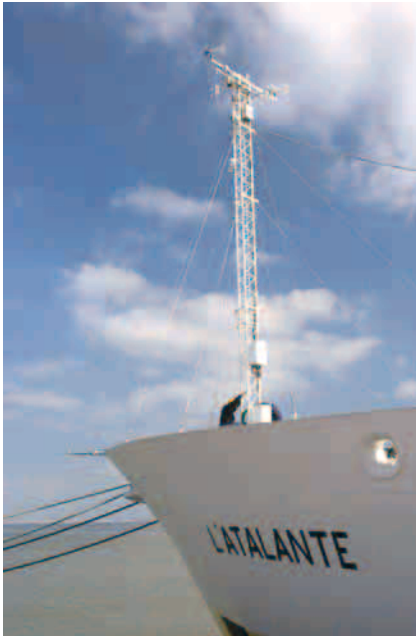
L' Atalante , navire océanographique de l'Ifremer, équipé d'un mât anémométrique et d'une perche de mesure à l'étrave lors de la campagne Pomme. (Photo Météo-France, P. Taburet)
