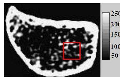
Fig.1 – Coupe scanner d'une tête de radius et extraction d'un échantillon d'os trabéculaire
