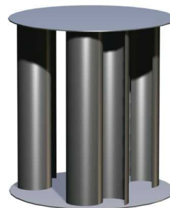
FIG. 5b – exemple : rotor à trois voilures
