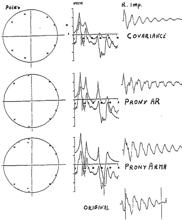
Figure 2 : Résultat de l'application du modèle au signal vocal
