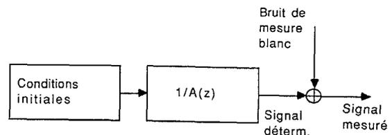
Figure 1 : Modèle de génération du signal
